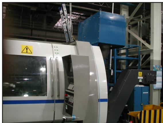
Odsávač Mechanic System typ GMO2 nasazený odsávání olejové mlhy na obráběcím centru.
