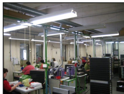
ABB, provozovna Brno - filtrační jednotka GM2V pro odsávání 11-ti pájecích pracovišť při výrobě elektrických jističů.
