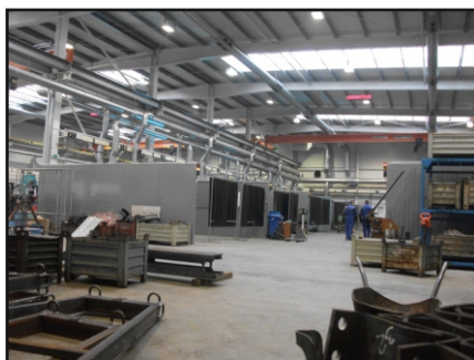
TDS Zampra, Frýdlant nad Ostravicí - 4x filtrační jednotka GM pro celoplošné centrální odsávání svařovny, a dále 13-ti brousících stolů a obrobny.
