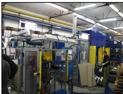
.... na obrázku jsou odsávaná pracoviště pro odporové svařování - robotizované pracoviště a ruční odporové lisy pro výrobu dílců pro automobilový průmysl.
