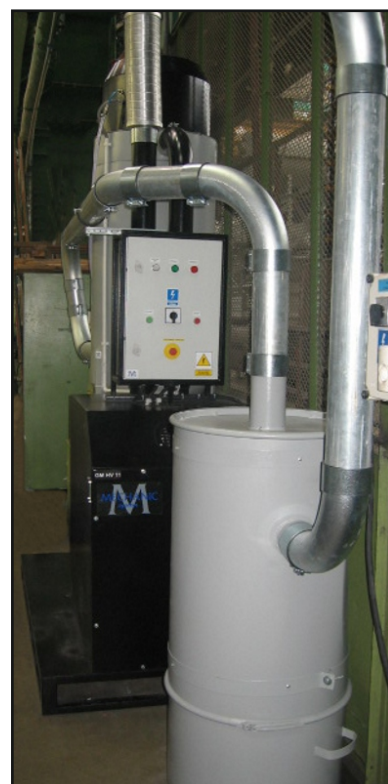
Vysoko podtlaková filtrační jednotka GMHV 1000 pro odsávání plastových pilin vznikajících při obrábění konců hadic pro automobilový průmysl. V popředí je velký zásobník plastových pilin.
